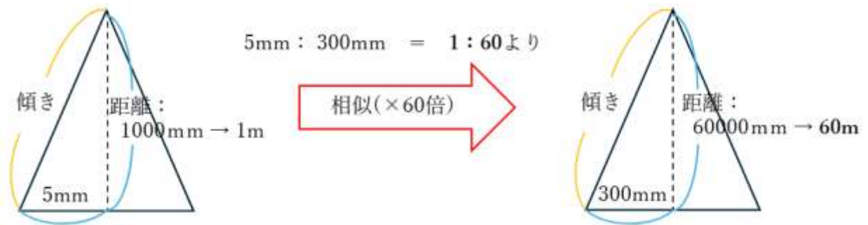
図 1：レトロリフレクターとドローンとの適切な距離の計算
