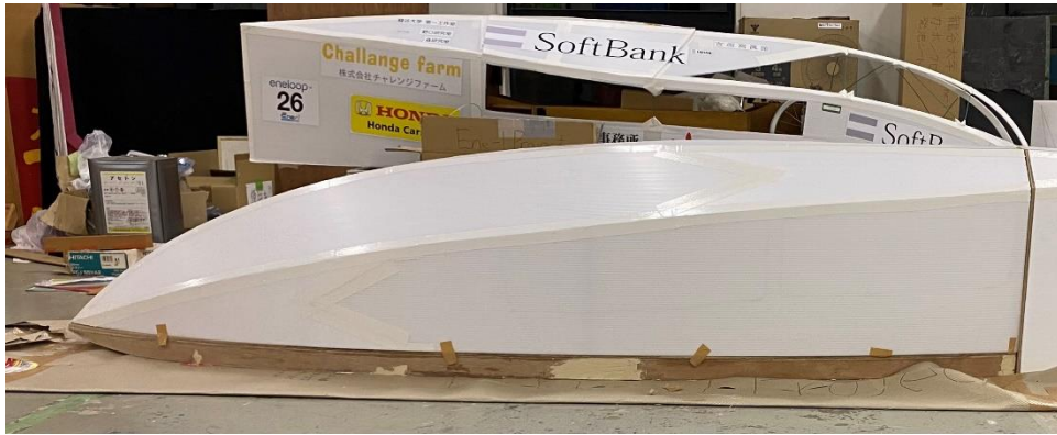
図9. 上面のカウルとアンダーカウルを仮に合わせている
