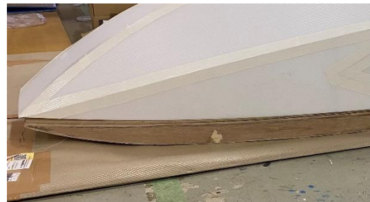
図6. 先端部分を少し上に反らしている
