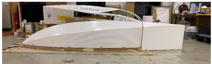
図11. すべてのカウルを仮合わせしている
