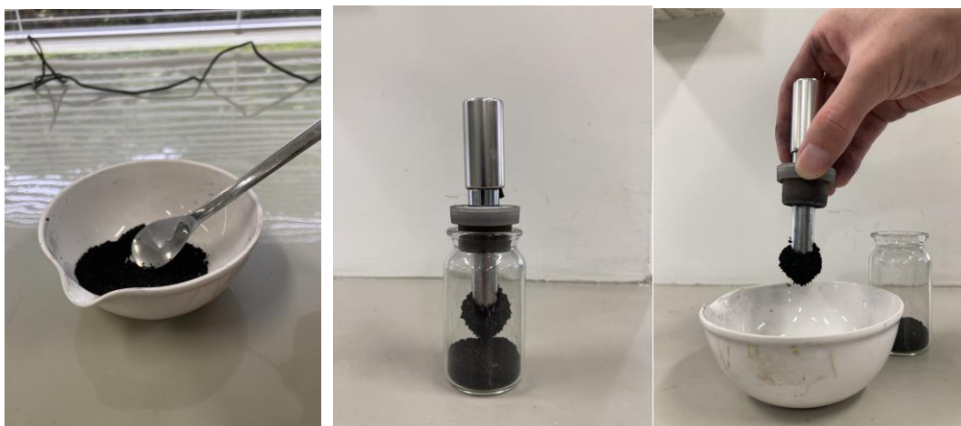
図□磁力選別試験の様子
