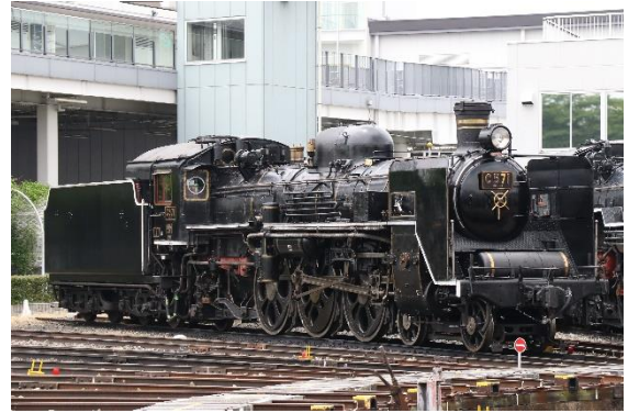
図 2-1-1 デフレクターを装備した機関車(C57 1)
