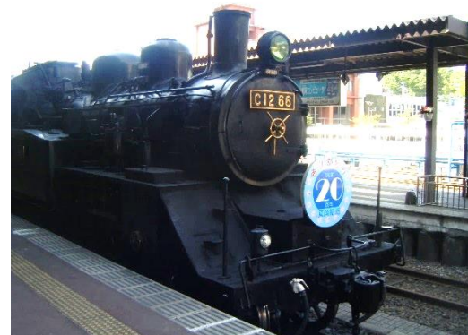
図 2-2-2 デフレクターを装備していない機関車(C12 形)
