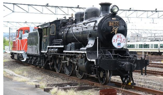
図 2-2-1 デフレクターを装備していない機関車(8620 形)
