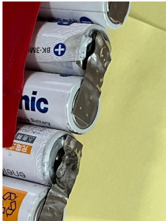
図 2-3-3-2 破損した電池の端子部分
