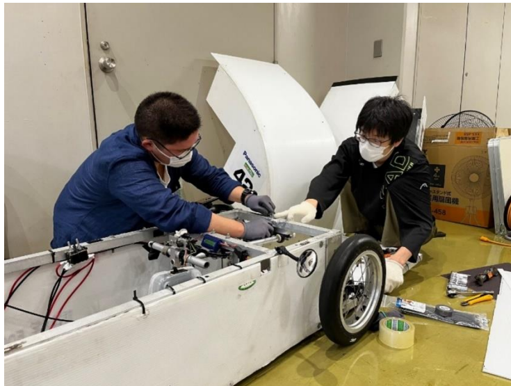
図 2-3-5-4 ボルト締結部の確認の様子
