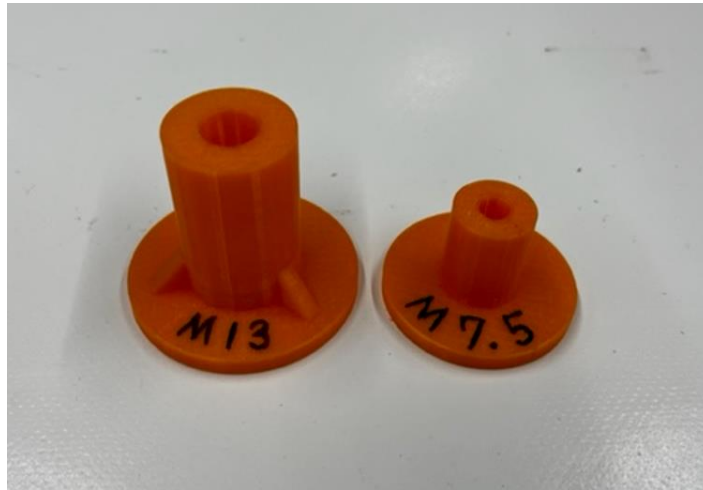
図 2-3-7-10 3D プリンター製穴あけ用治具
