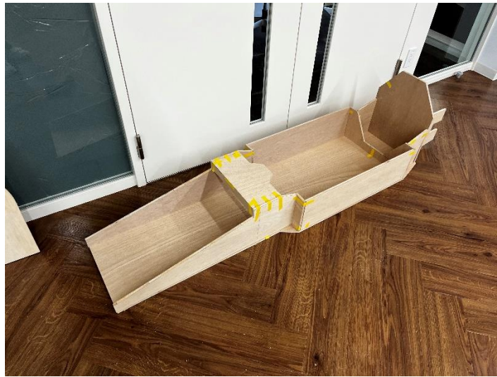
図 2-3-7-8 仮組した車体
