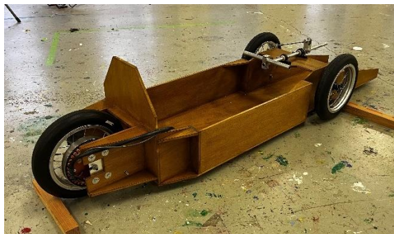
図 2-3-8-5 車輪とモータを取り付けた車体の様子
