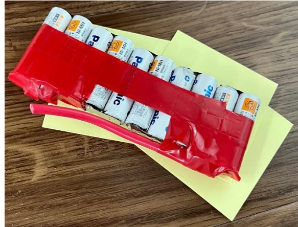
図 2-3-3-3 破損した電池の全体図
