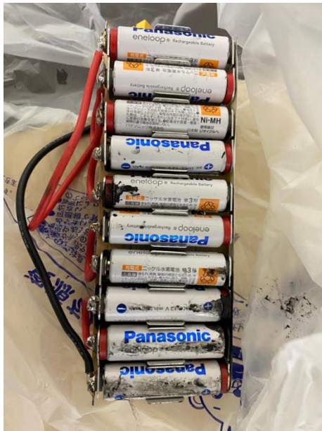
図 2-3-9-6 破裂したバッテリー
