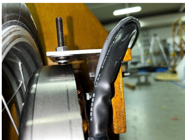
図 2-3-8-15 L字にすることで、ブレーキを強くかけてもステーがずれることは無い。
