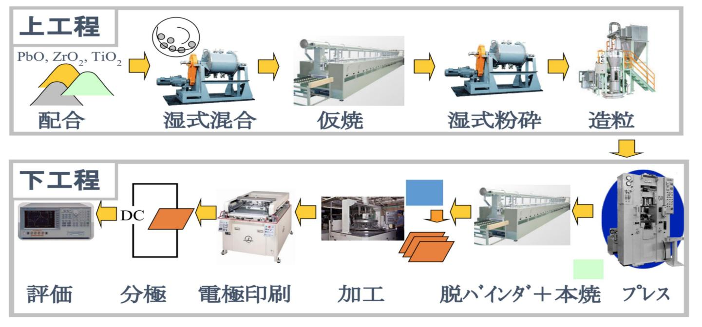
リードテクノ株式会社にて、圧電セラミックスの基礎知識、 作製方法などを学んだ。上記の図は、圧電セラミックスの
