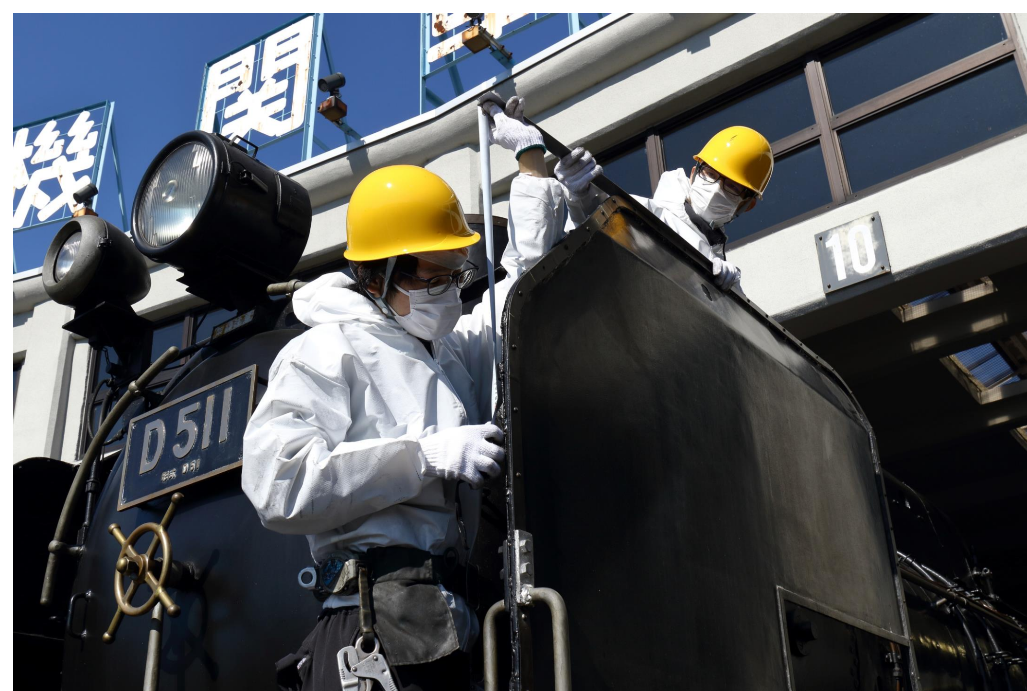
京都鉄道博物館で1号機のデフレクターを計測して3Dモデル作成
