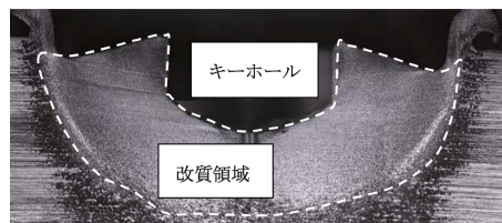
図2 断面観察結果 (FSP)
