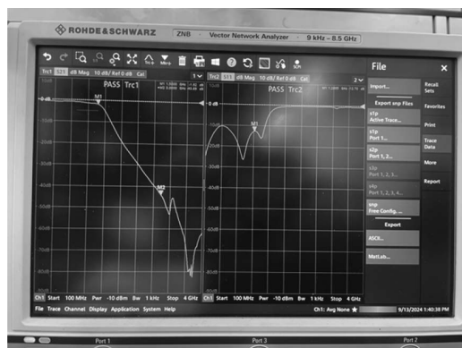
図7 5段低域通過フィルタの特性評価
