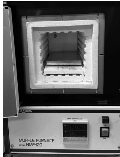
図 10 A2017 材の焼き入れ処理の様子
