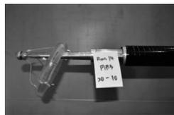
図4 スティングと天秤を含む試験模型の実験画像
