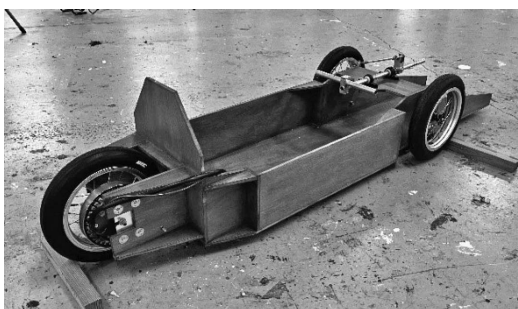
図 4-3-9 車輪とモータを取り付けた様子
