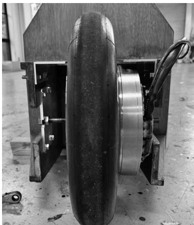
図 4-3-10 ブレーキマスターを装着した様子
