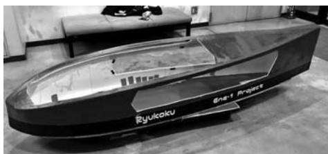
図4 塗装, 窓部切り出し
