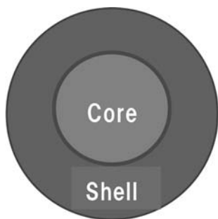
Fig. 1 Core/Shell 型量子ドットの構造
