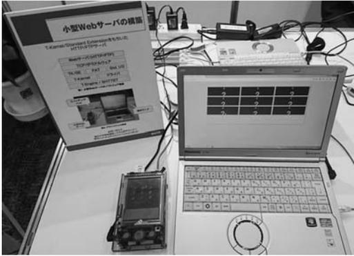
図2 TRON上で動作するWebサーバ
