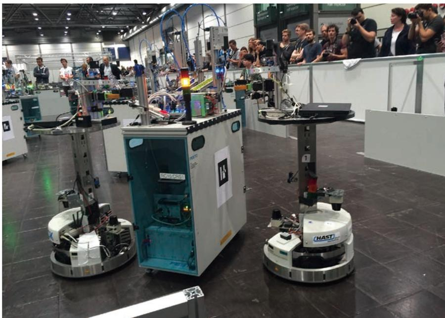
Logistics League : 変種変量の製品を作るため、移動式ロボットが素材となるワークを加工するマシン (MPS) の元へ運ぶ
