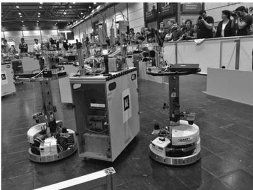
図1 Logistics League では、変種変量の製品を作るため、移動式ロボットが素材となるワークを加工するマシン（MPS）の元へ運ぶ。
