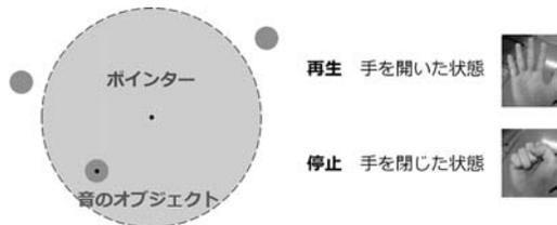
図3 手の形状による再生・停止の操作
