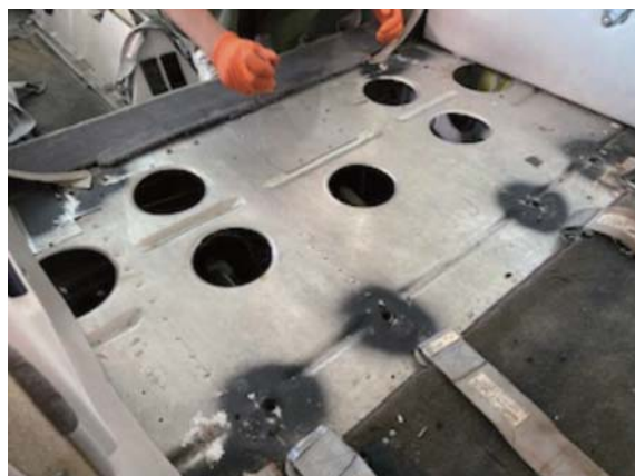
図 20 フロアマットをはがした状態
