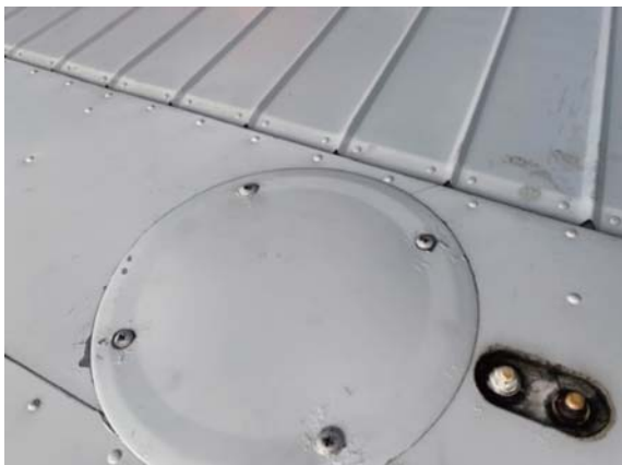
図 10 パネルが閉められた状態
