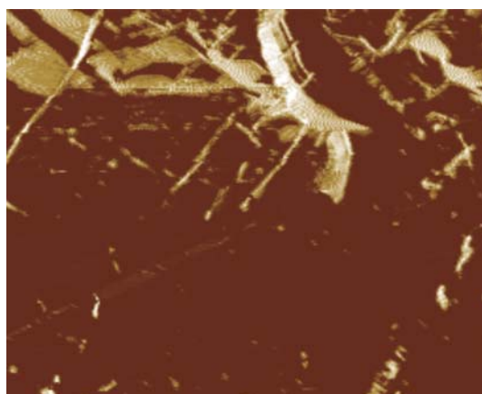
Fig. 13 AFM で観察したグラフェンの試料
