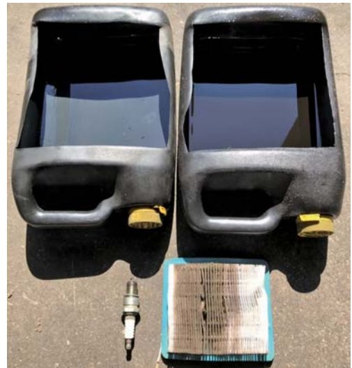
図1 取り除いたエンジンオイル、ガソリン、スパークプラグ、エアフィルター
