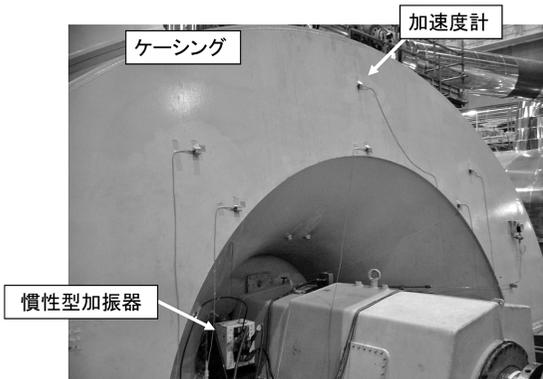
図4 大型蒸気タービンの加振試験状況
