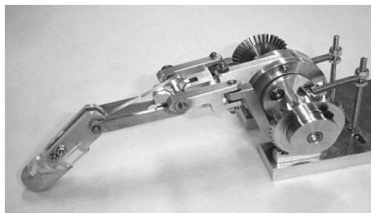
図3 複合遊星ギアを用いたロボットフィンガー
