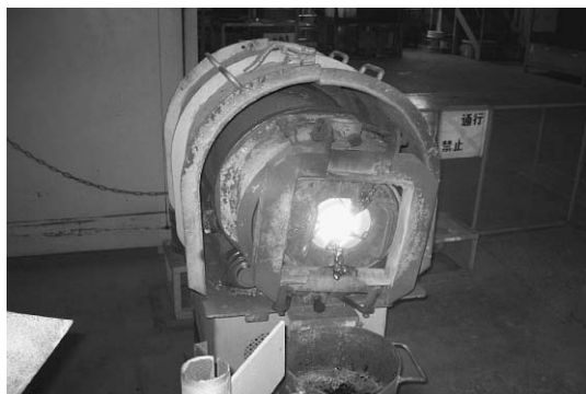
図3 回転侵食試験装置
