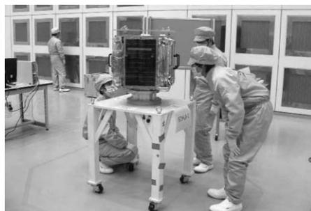
**Fig. 11 龍大ブームチームによるブームの健全性確認作業**
