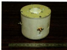
携帯基地局用マルチモードフィルタ
