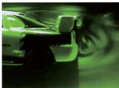
模型自動車まわりの流れの可視化結果
