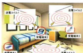
3Dフリーアクセス無線電力伝送システム (スマートフォンを知らないうちに充電)
