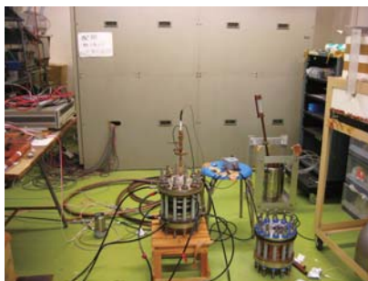
パルス磁場発生装置。最高で 40 T（40 万ガウス）の強磁場が発生可能。
