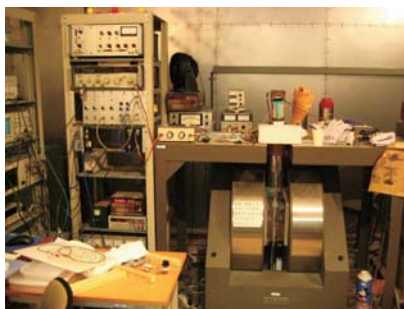
核磁気共鳴 (NMR) 実験装置。電磁石と組み合わせてミクロな磁性を探索。
