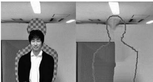
図 8 人物サイズが変更されると、元の人物画像に隠れていた部分の背景が得られない(左図)。これを解決するため、提案システムでは元の人物画像領域に画像修復を行い補間している(右図の赤線内部)
