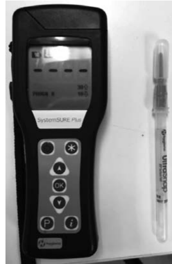
図2 ATP 拭き取り検査器具 (左：本体、右：検査キット。下部に綿棒が内蔵されている)
