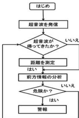
図3 実験装置のフローチャート
